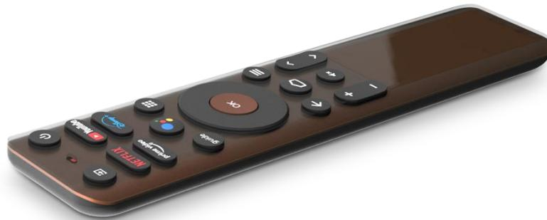
建基於 Omni 的低功耗硬件平台，Model P 支持標準語音命令、藍牙和紅外線按鍵，而在待機時幾乎不消耗電流。透過先進的太陽能收集技術，Model P 獲每天 8 小時的室內照明後，即可永久運行。在完全黑暗的情況下，其內置的電力儲備也可以維持 4 個月的運作。
